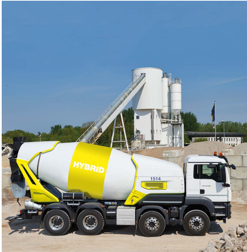
Bei diesem Hybrid-Transportbetonfahrmischer sorgt ein Elektromotor für den Antrieb der Mischertrommel. Die CO 2 -Emissionen sinken und die Lärmentwicklung ist geringer.
